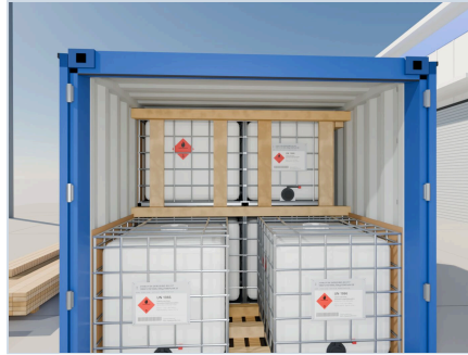
11 Верхний щит на втором ярусе четвёртого ряда: 4 стойки под 2 брусками 100×100
