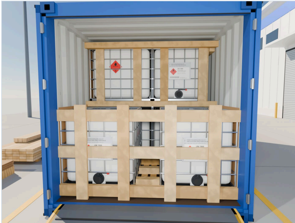
ФОТО ЭТАПА 12 Дверной проём со щитом
