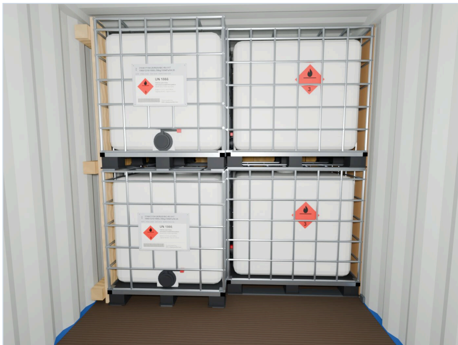
ФОТО ЭТАПА 05 Первый полный ряд от торцевой стены
