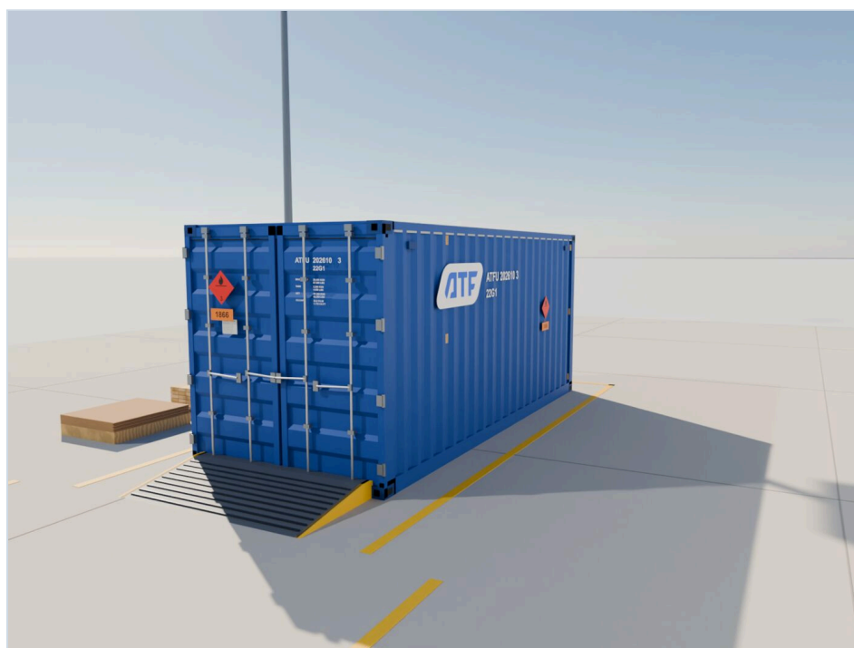
ФОТО ЭТАПА 14 Контейнер закрыт, знаки опасности 250×250 мм с четырёх сторон
