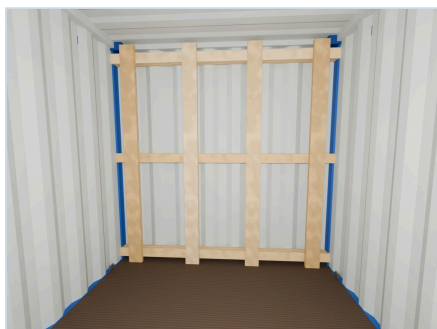
04 Торцевой щит: 3 бруса 100×100 у стены, концы в гофра, поверх — 4 вертикальные доски
