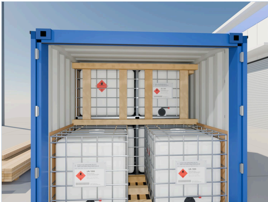
ФОТО ЭТАПА 11 Верхний щит на втором ярусе четвёртого ряда: 4 стойки под 2 брусьями 100×100
