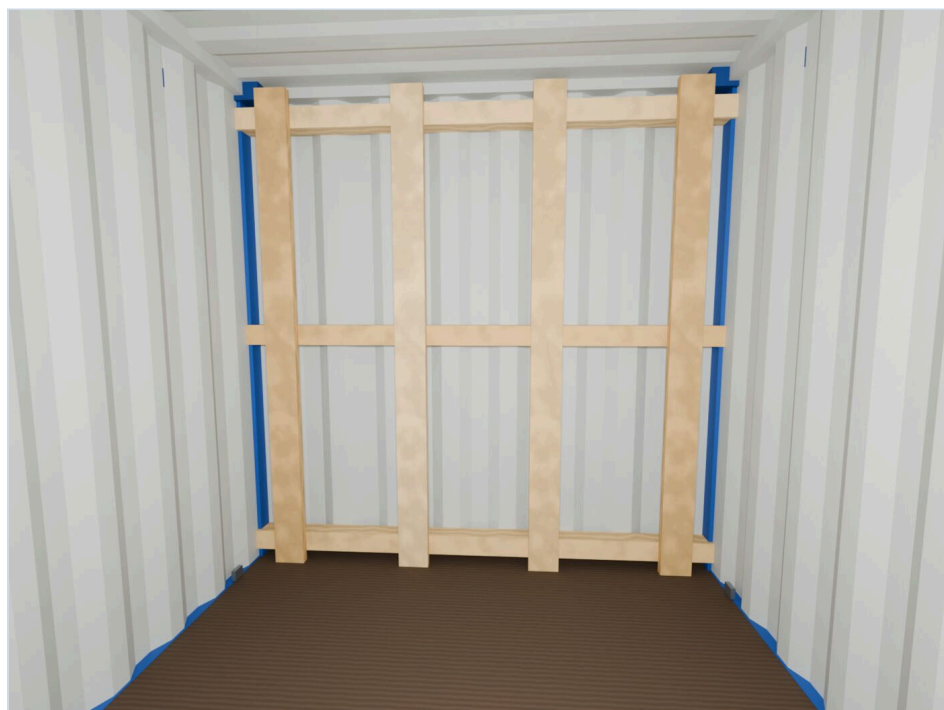
ФОТО ЭТАПА 04 Торцевой щит: 3 бруса 100×100 у стены, концы в гофра, поверх — 4 вертикальные доски
