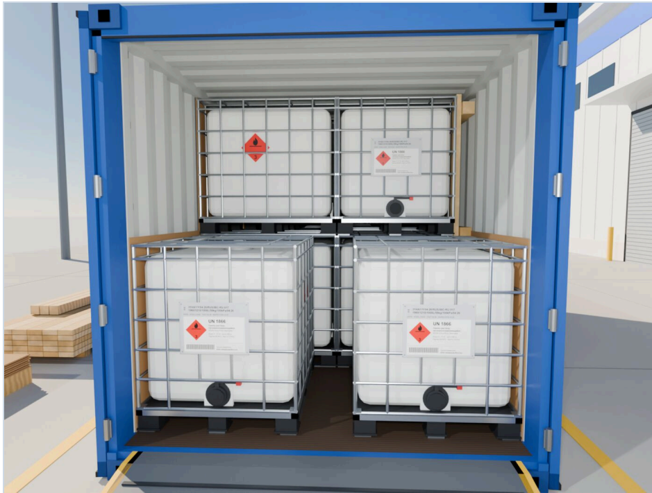
ФОТО ЭТАПА 09 Пятый ряд: 2 куба у боковых стен, по бокам картон — дверной проём без щита
