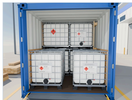
09 Пятый ряд: 2 куба у боковых стен, по бокам картон — дверной проём без щита
