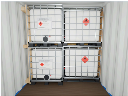
05 靠端墙的第一整排
