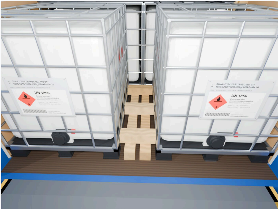
阶段照片 10 第五排吨桶之间的止挡结构：100×100止挡方木与中间方木
