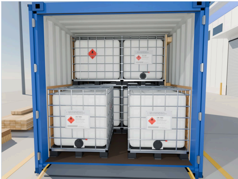
阶段照片 09 第五排：2个吨桶靠两侧壁，两侧垫纸板——未装挡板的门口
