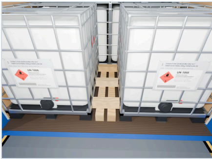
10 第五排吨桶之间的止挡结构：100×100止挡方木与中间方木
