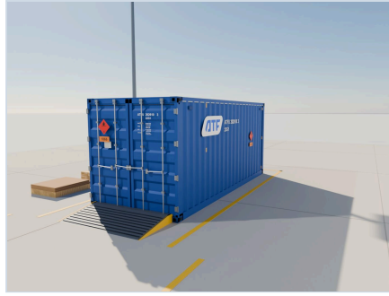
14 集装箱已关闭，四面贴有250×250毫米危险品标志
