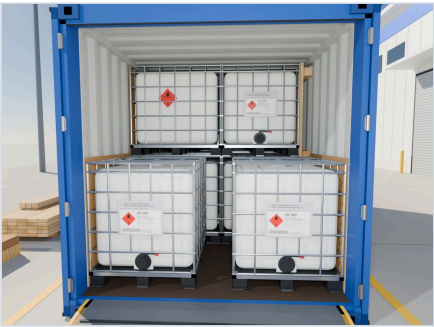
09 第五排：2个吨桶靠两侧壁，两侧垫纸板——未装挡板的门口
