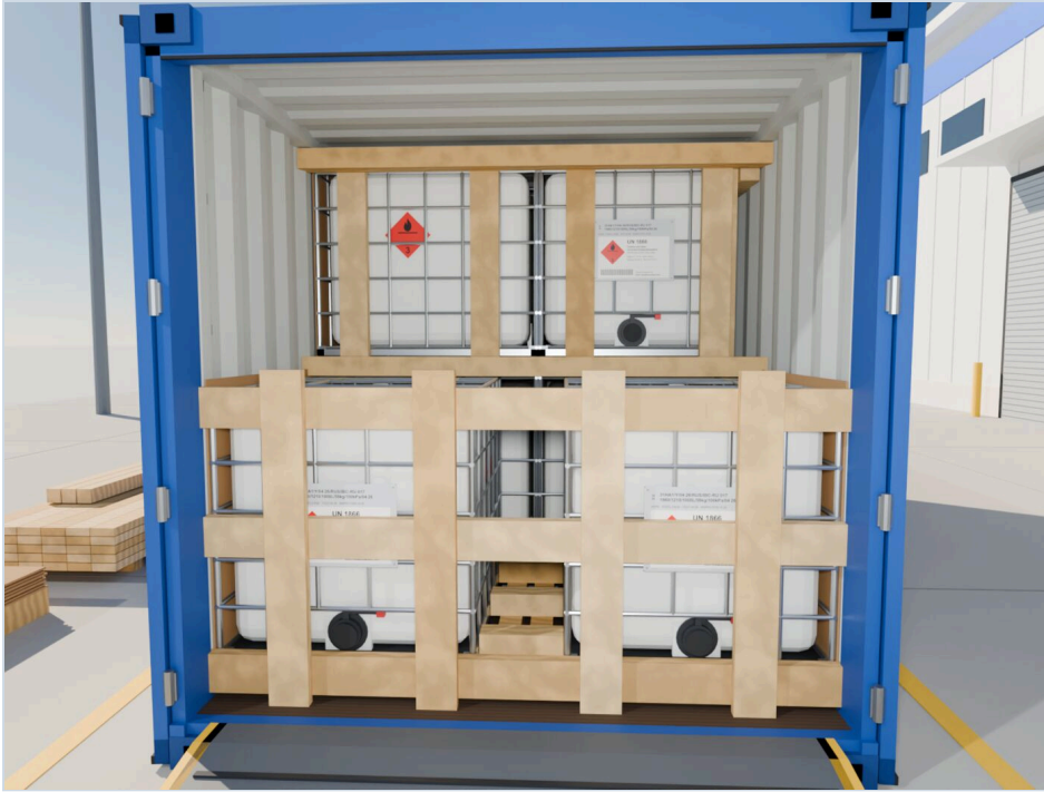
阶段照片 12 装好挡板的门口
