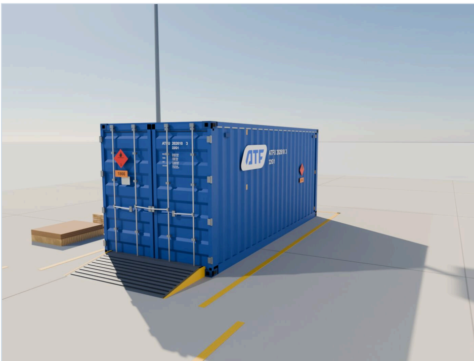
阶段照片 14 集装箱已关闭，四面贴有250×250毫米危险品标志
