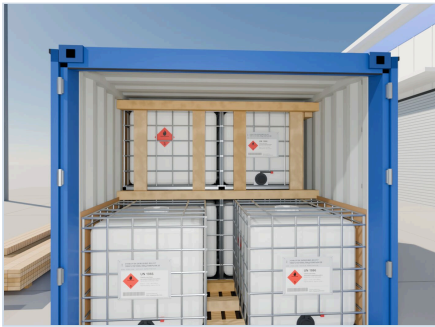
11 第四排第二层的上部挡板：2根100×100方木下的4根立柱
