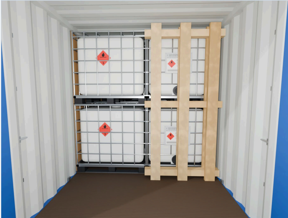
ФОТО ЭТАПА 09 Упорный щит на половину ширины после четвёртого ряда
