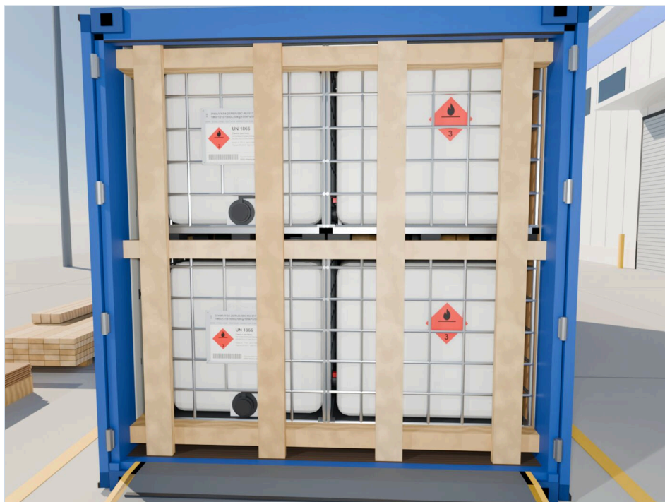
ФОТО ЭТАПА 11 Дверной проём со щитом
