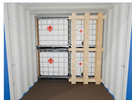
09 Упорный щит на половину ширины после четвёртого ряда
