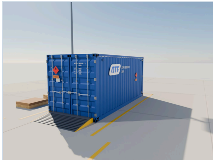
13 Контейнер закрыт, знаки опасности 250×250 мм с четырёх сторон
