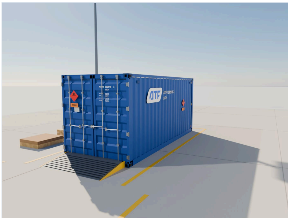
ФОТО ЭТАПА 13 Контейнер закрыт, знаки опасности 250×250 мм с четырёх сторон
