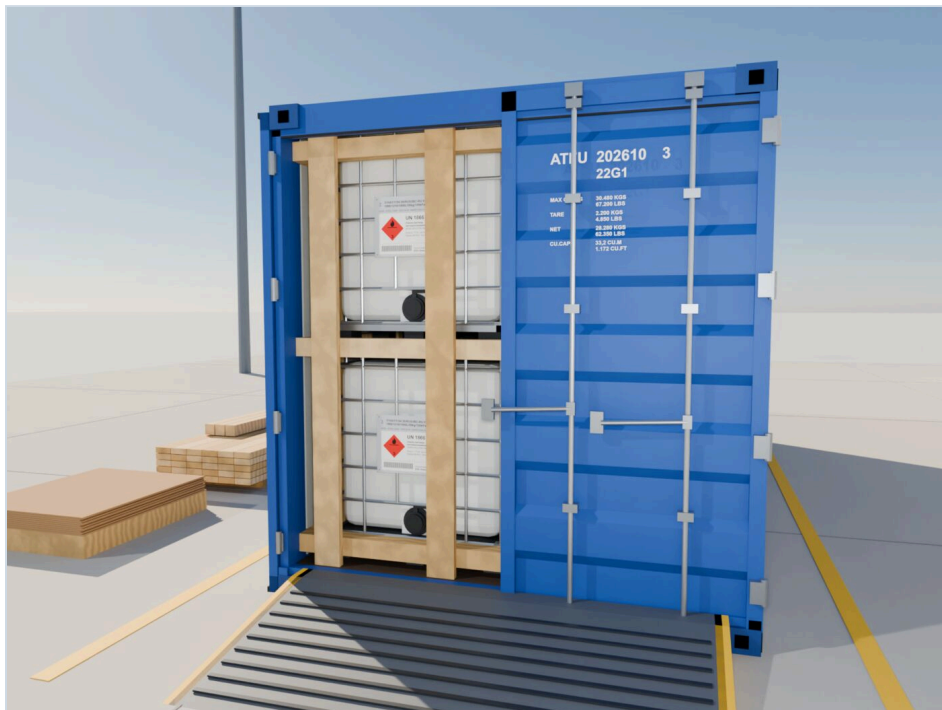
ФОТО ЭТАПА 12 Одна дверь закрыта — виден номер контейнера
