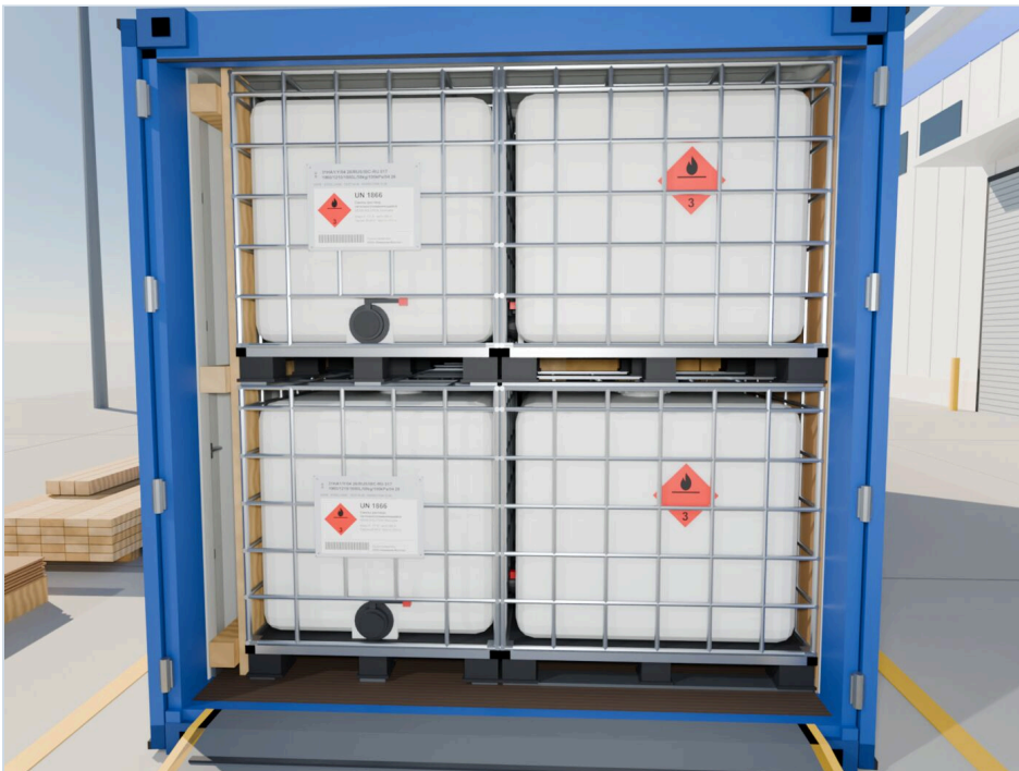
ФОТО ЭТАПА 10 Дверной проём без щита
