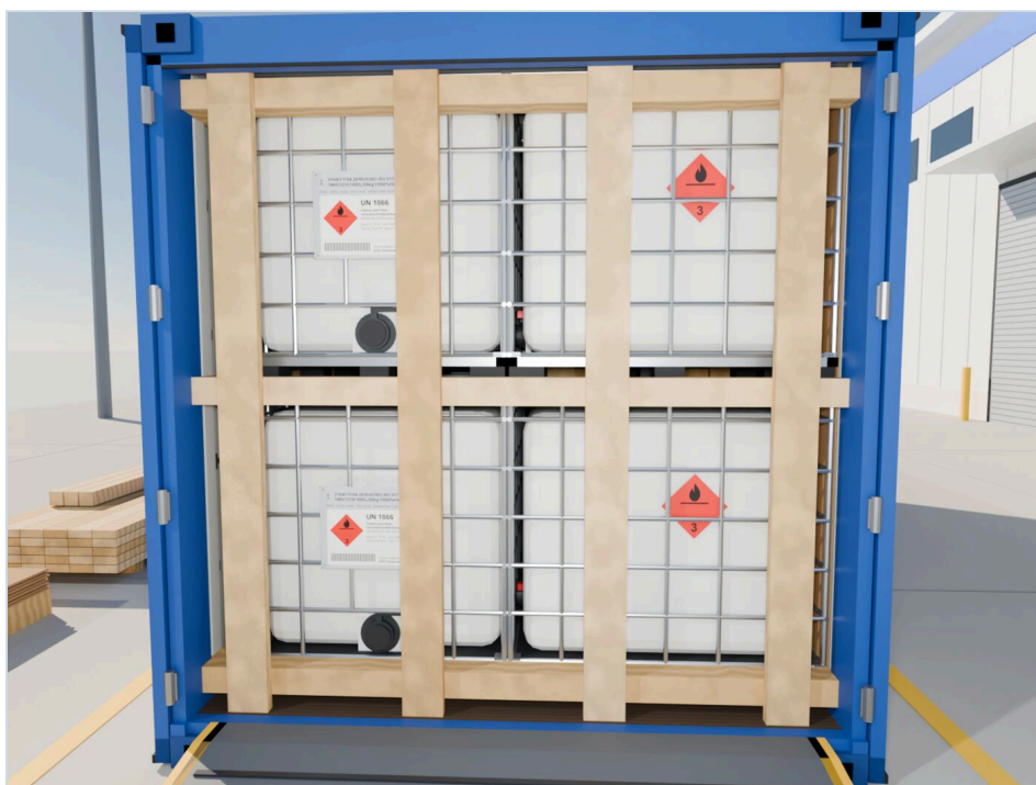
阶段照片 11 装好挡板的门口
