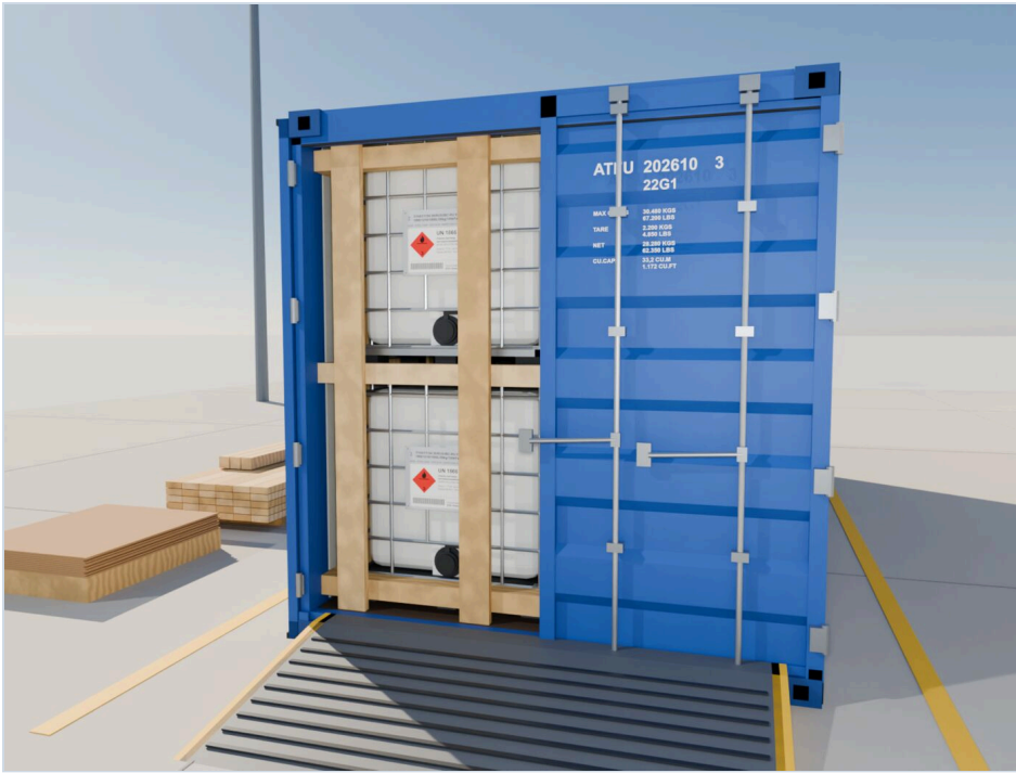
阶段照片 12 关闭一扇门——可见集装箱号
