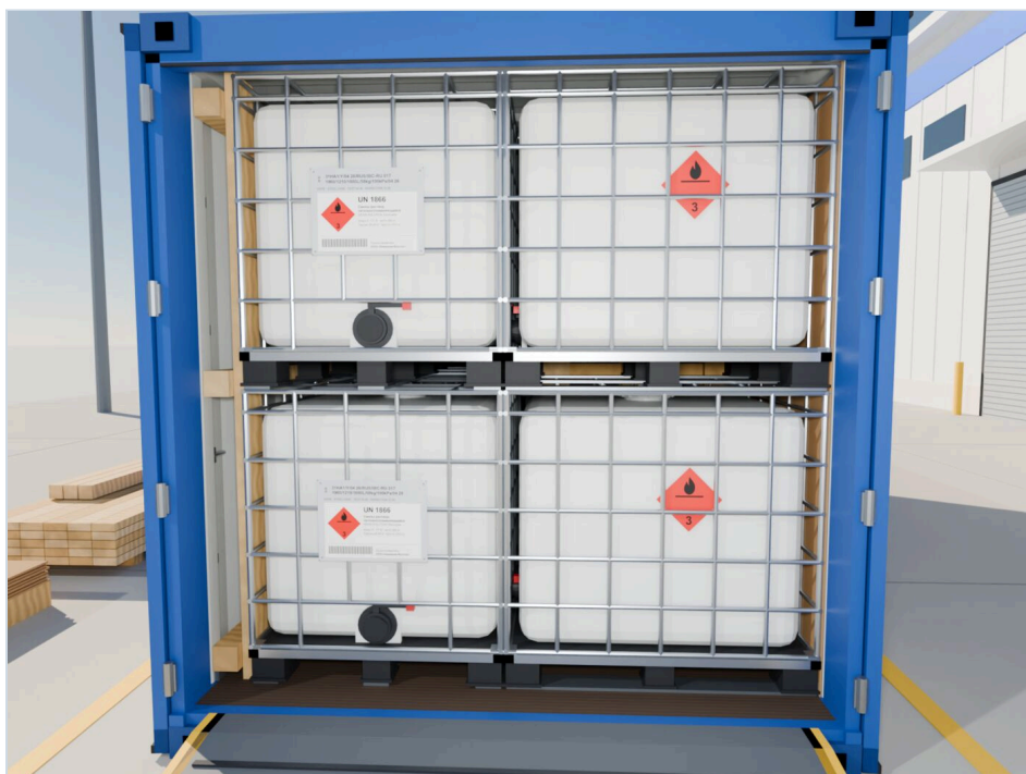
阶段照片 10 未装挡板的门口
