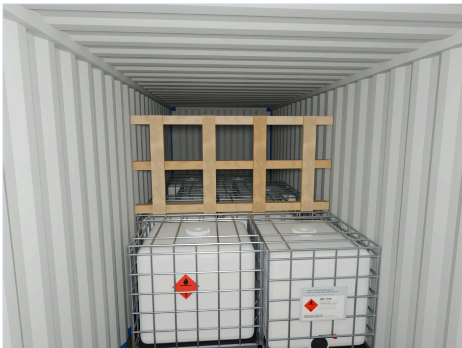
ФОТО ЭТАПА 09 Щит второго яруса со стороны торца: 3 бруса поз. 6, 4 стойки поз. 10
