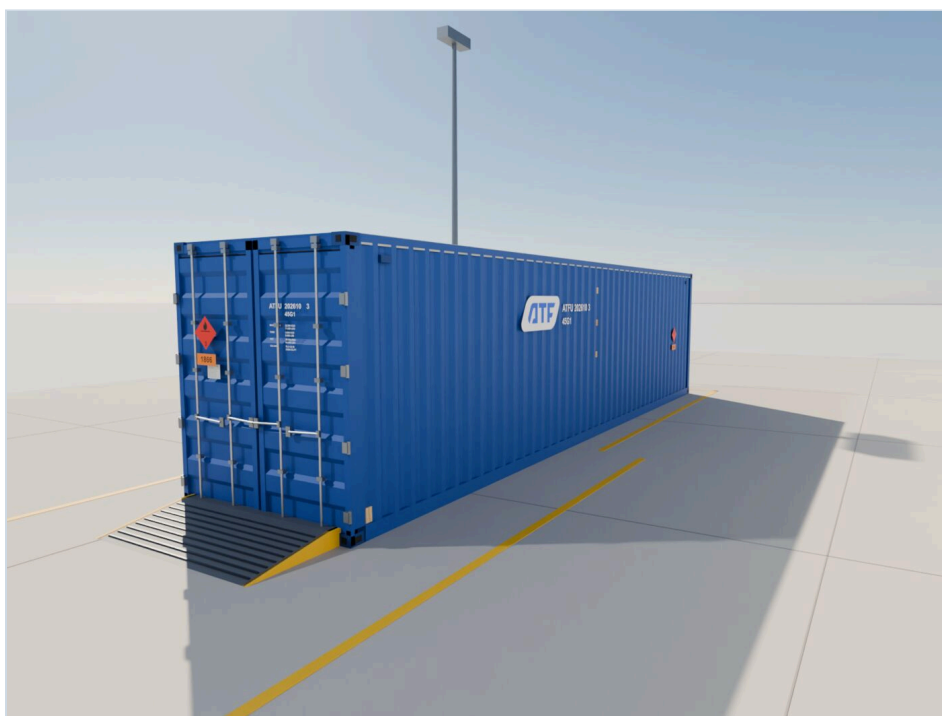
ФОТО ЭТАПА 21 Контейнер закрыт, знаки опасности с четырёх сторон (для опасного груза)
