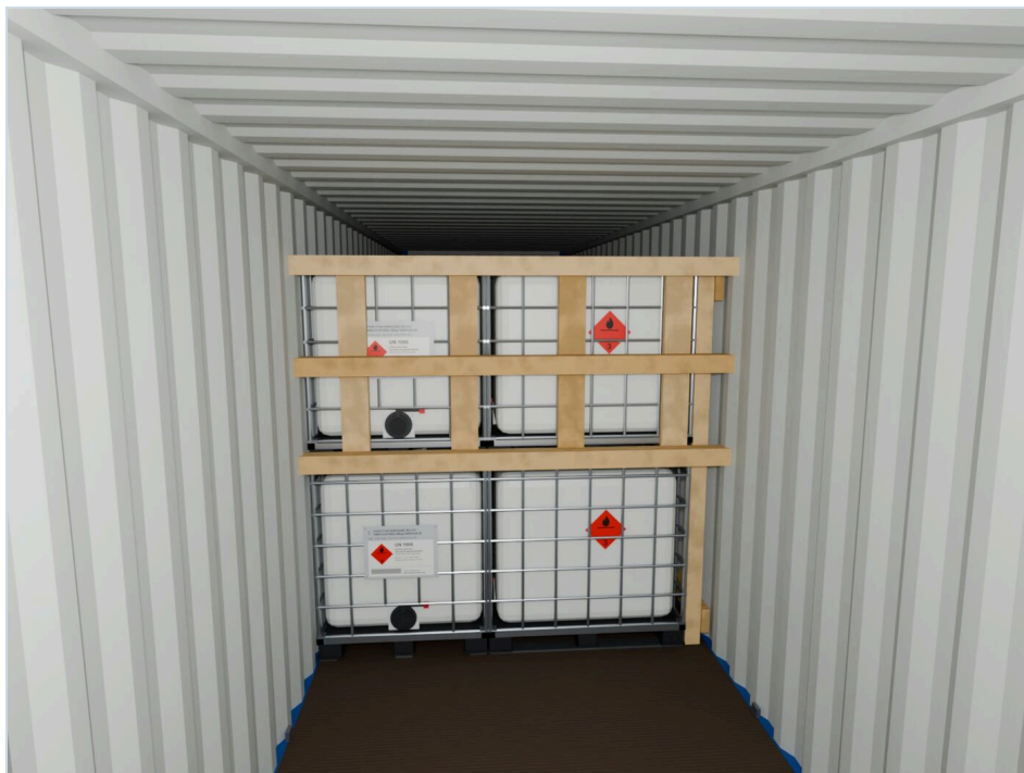
ФОТО ЭТАПА 13 Щит второго яруса со стороны дверей
