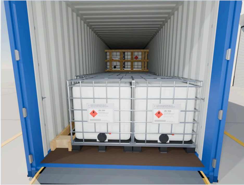
ФОТО ЭТАПА 18 Ряд 10: места 23 и 24 — дверной проём без щита
