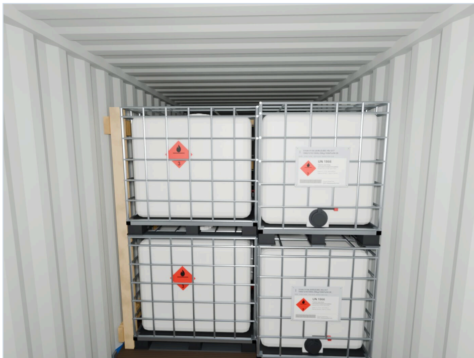
ФОТО ЭТАПА 10 Ряд 4, второй ярус: места 9 и 10, щит у левой стены
