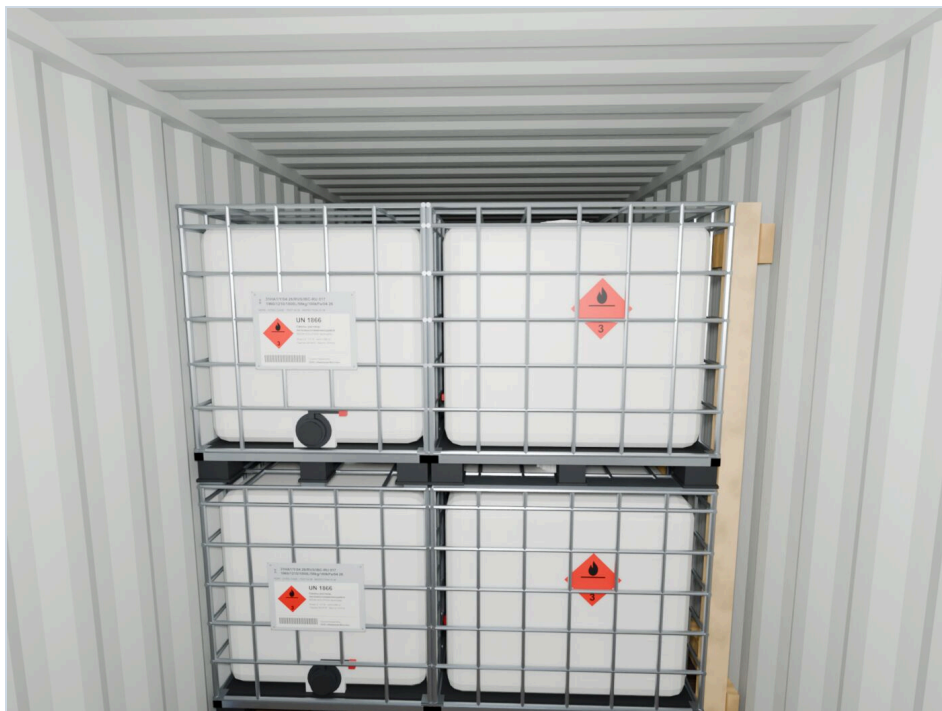
ФОТО ЭТАПА 12 Ряд 5, второй ярус: места 13 и 14, щит у правой стены
