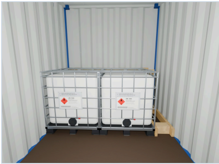
05 第1排：1、2号货物，右侧壁止挡结构 从箱门方向沿集装箱中轴线、距该排约2米、高度1.5米拍摄：该排两件货物全貌、侧壁处的加固件及地板。
