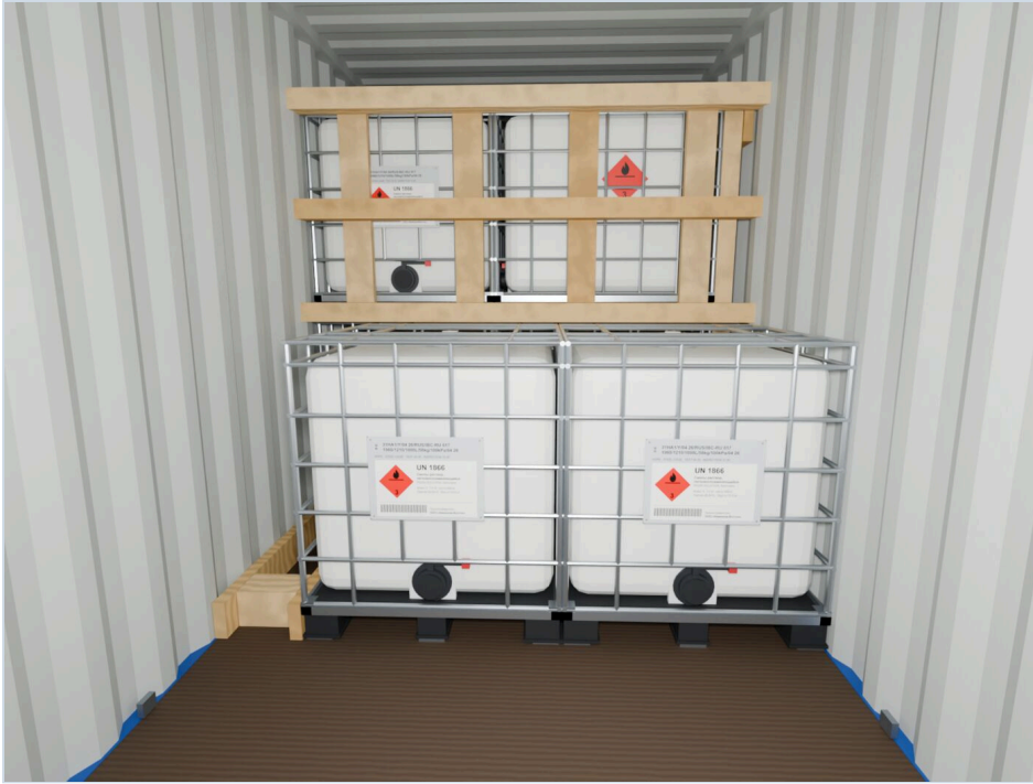
阶段照片 14 第6排：15、16号货物，左侧壁止挡结构
