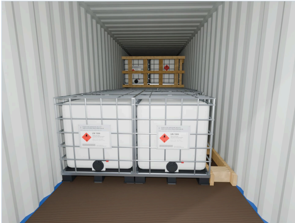
阶段照片 17 第9排：21、22号货物，右侧壁止挡结构
