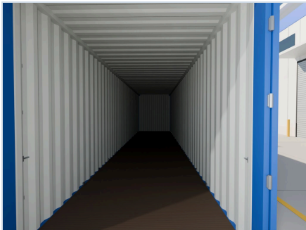
02 装货前的40英尺集装箱：地板、侧壁、顶板、箱门 箱门打开，从门口向箱内拍摄：整个长度的地板、侧壁和顶板。
