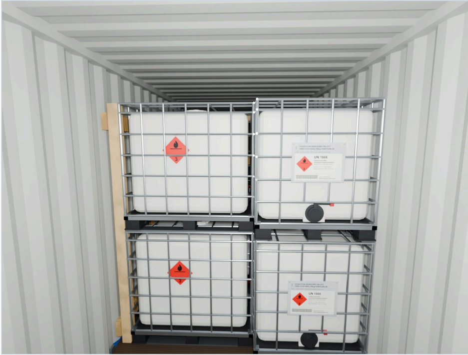
阶段照片 10 第4排第二层：9、10号货物，左侧壁挡板
