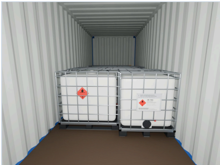
08 第4排第一层：7、8号货物 从箱门方向沿集装箱中轴线、距该排约2米、高度1.5米拍摄：该排两件货物全貌、侧壁处的加固件及地板。
