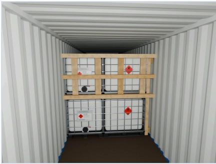
13 箱门侧第二层挡板 从箱门方向、在第一层上方约2.2米高度拍摄：第二层挡板全貌——3根方木、4根立柱，方木端头嵌入波纹。
