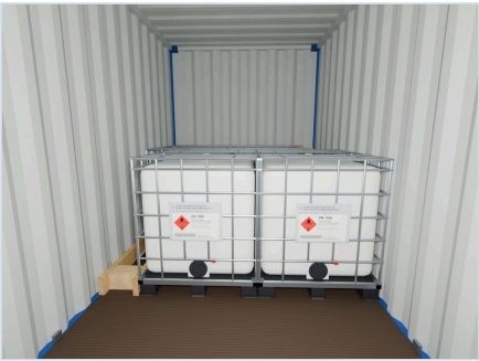
06 第2排：3、4号货物，左侧壁止挡结构 从箱门方向沿集装箱中轴线、距该排约2米、高度1.5米拍摄：该排两件货物全貌、侧壁处的加固件及地板。
