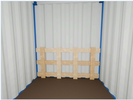
04 端墙挡板：靠墙3根横板（4号件），4根竖板（3号件） 在箱内距端墙2~3米处拍摄：整块挡板，横板端头嵌入波纹。
