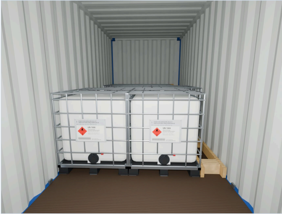
阶段照片 07 第3排：5、6号货物，右侧壁止挡结构
