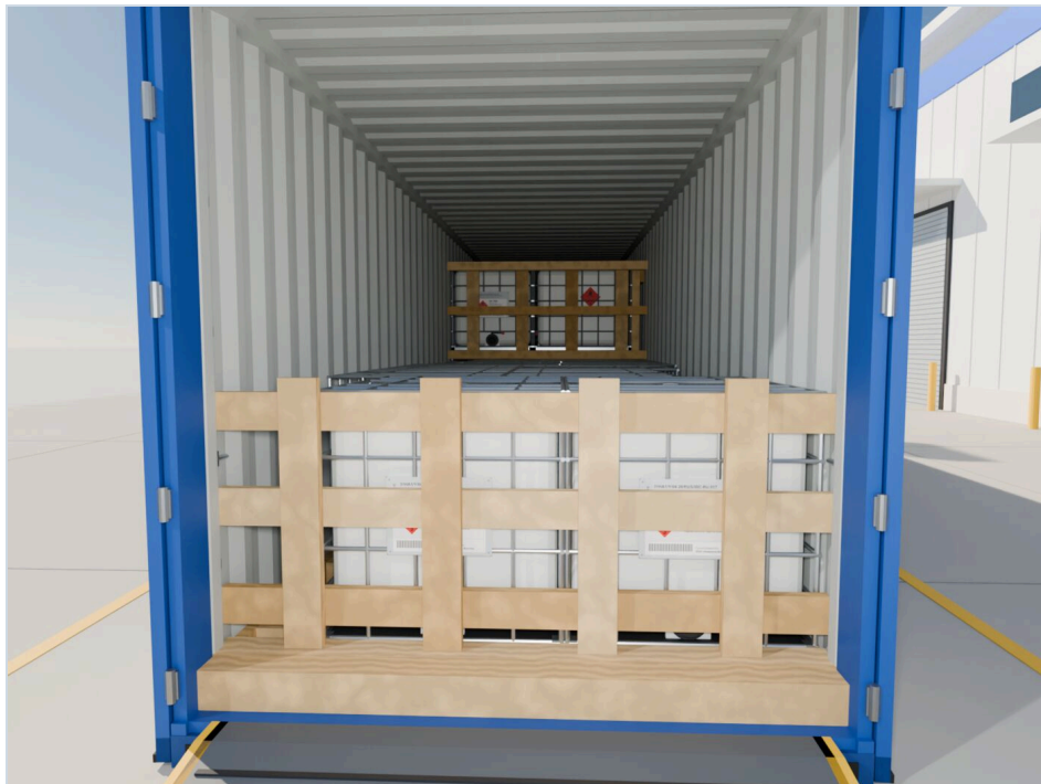
阶段照片 19 装有挡板和1号止挡方木的门口
