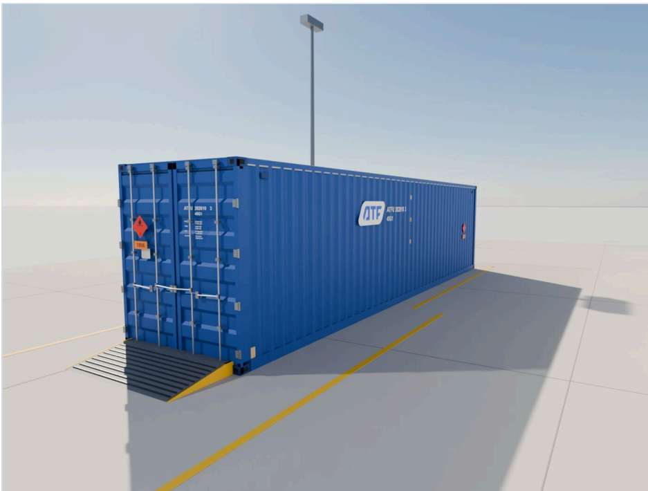
阶段照片 21 集装箱已关闭, 四面贴有危险品标志 (危险货物)
