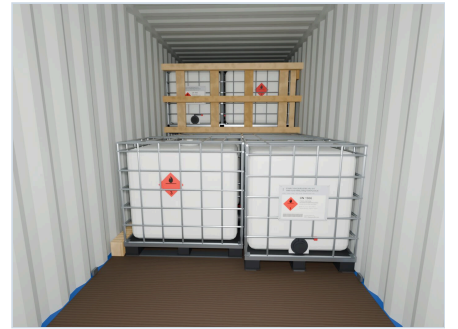
15 第7排：17、18号货物，左侧壁7号方木 从箱门方向沿集装箱中轴线、距该排约2米、高度1.5米拍摄：该排两件货物全貌、侧壁处的加固件及地板。
