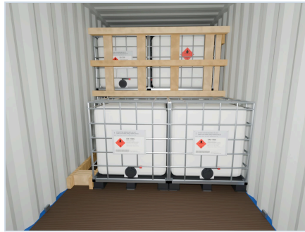
14 第6排：15、16号货物，左侧壁止挡结构 从箱门方向沿集装箱中轴线、距该排约2米、高度1.5米拍摄：该排两件货物全貌、侧壁处的加固件及地板。
