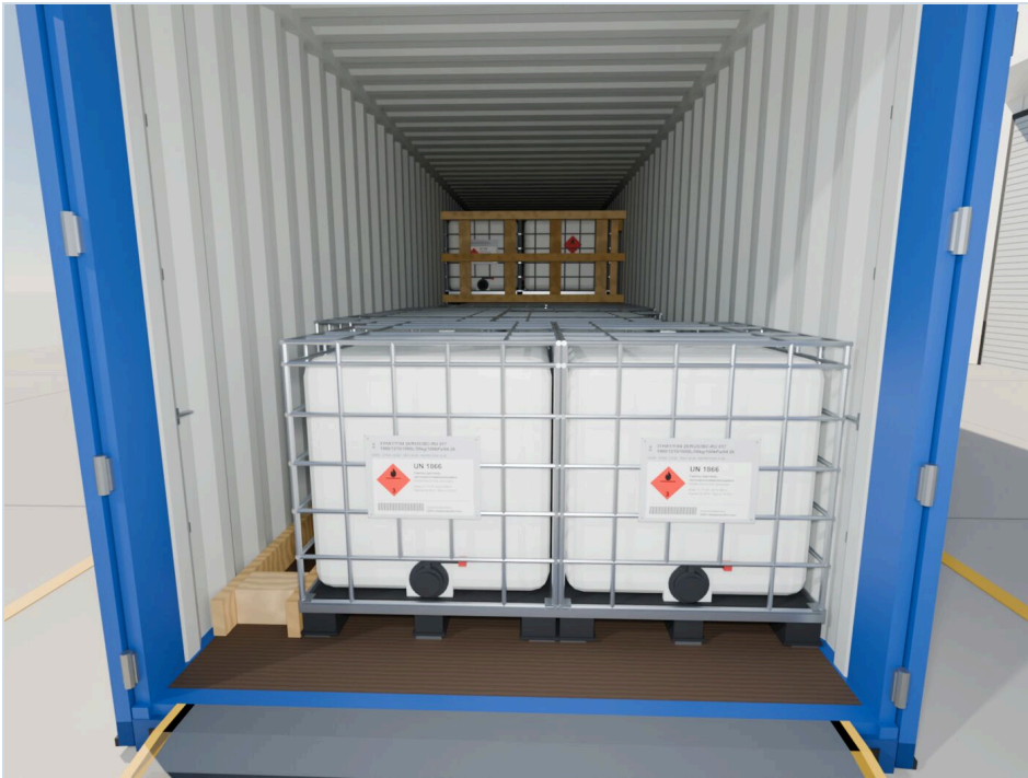
阶段照片 18 第10排：23、24号货物——未装挡板的门口
